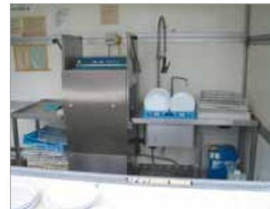
Das Geschirrmobil ist, wie auf dem Foto zu sehen, ein begehrter Anhänger, der mit einer Gewerbedurchschubspülmaschine und einem Zulaufschlauch mit Becken ausgestattet ist.
